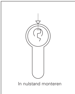
Meeneemstand van halfprofielcilinderslot (max. lengte 40 mm) bij 1-polige sleutelschakelaar.
