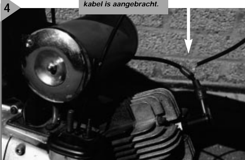
Figuur 4. Duidelijk is zichtbaar hoe de oppikspoel (25 windingen) op de bougiekabel is aangebracht.
